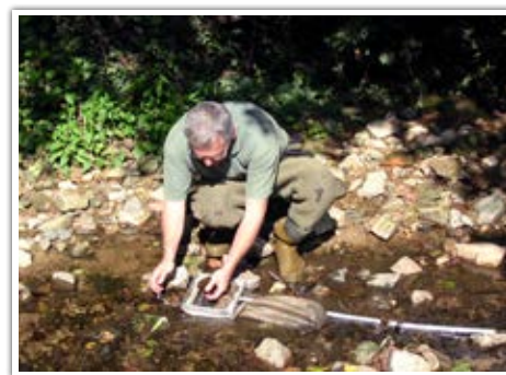
Prélèvement de macro-invertébrés benthiques en vue d'une analyse en laboratoire
